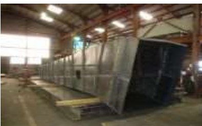
・トンネルダクト(SS)
