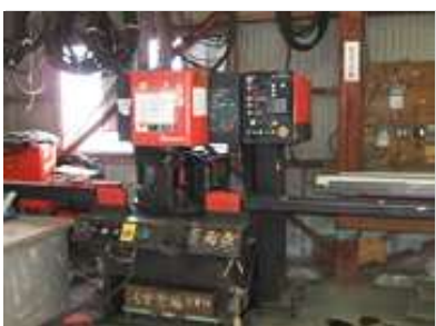
アイアンワーカー ・アマダIW45 II ・45t・アングル 9t×75 ・FB 9t×125
