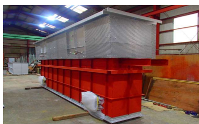
・バイオマス発電用主灰シュート
