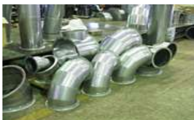
・ダクト(SUS304)製作
