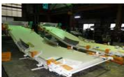
・蛇行防止コンベヤー
