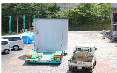
・半導体工場向け動力ろ過装置
