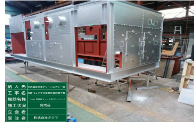
小野田バイオマス発電所 ・ケーシング
